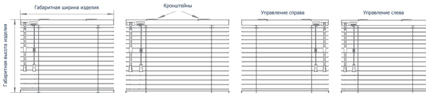
Разметьте места крепления кронштейнов равномерно по ширине изделия. При разметке необходимо учитывать, чтобы кронштейны не попадали на суппорт, механизм управления или фиксатор.
