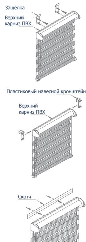
**ВНИМАНИЕ!** При монтаже на металлические защелки и на пластиковые навесные кронштейны используется дополнительная комплектация.
